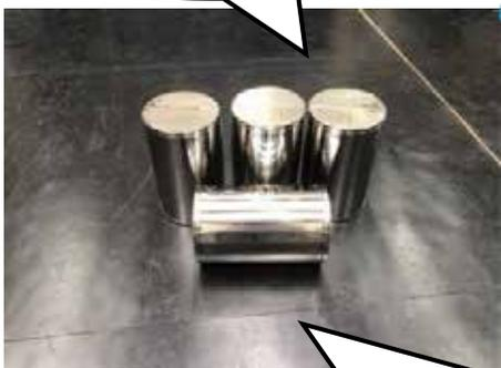
配管の基本的接続部品の一つ、フランジを保護するためのステンレスカバー
