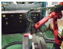
YAGレーザー溶接機 YLR15002
